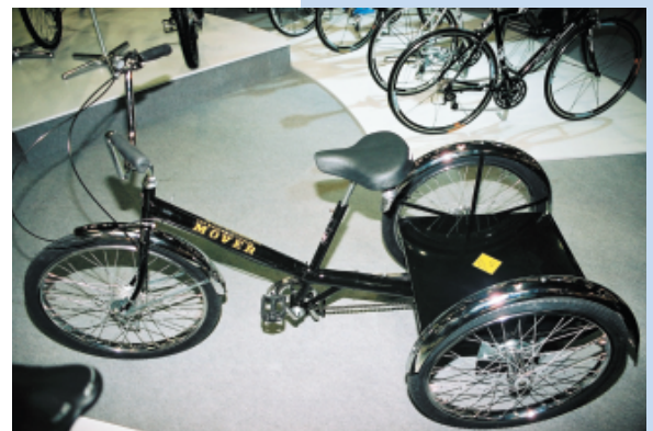
Speedliner Mover M 2626, stabiler Hecklader für Werkstransporte.
